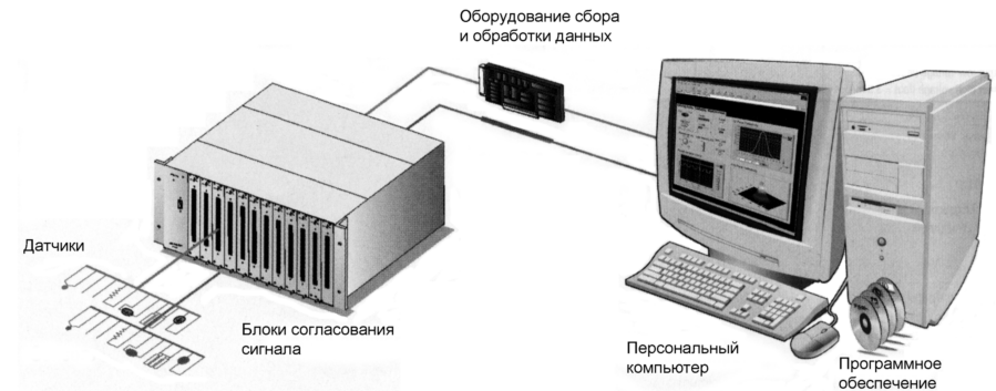
Рис. 3.11. Типовая функциональная схема компьютерной измерительной системы, включающей датчики, блоки согласования сигналов и плату сбора данных
